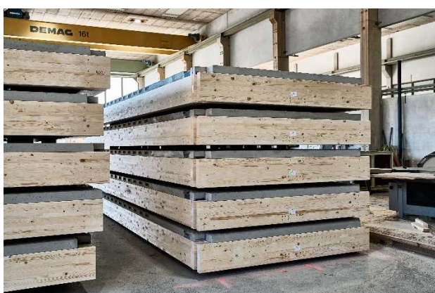
Die ausgeklügelten XC® Holzbeton-Verbunddecken der MMK wurden bei der Kirchdorfer Tochter RAUTER im steirischen Murtal auf clevere Weise „verbunden“. Abdruck honorarfrei bei Nennung des Copyrights © Kirchdorfer Gruppe
