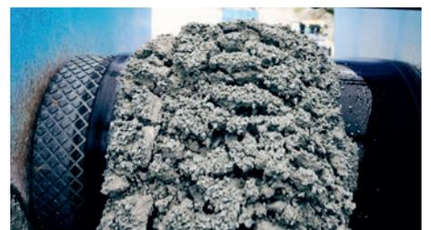
**Straßenbau ohne Bindemittel:** Kámen a písek verfügt sowohl über mobile als auch permanente Produktionslinien, auf denen pro Tag bis zu 2.000 Tonnen Mineralbeton bereitgestellt werden können. Wie KAP-Geschäftsführer Ing. Pavel Fučík demonstriert (rechts oben), wird Mineralbeton auf der Baustelle einfach mit einer regulären Asphaltiermaschine verlegt.
