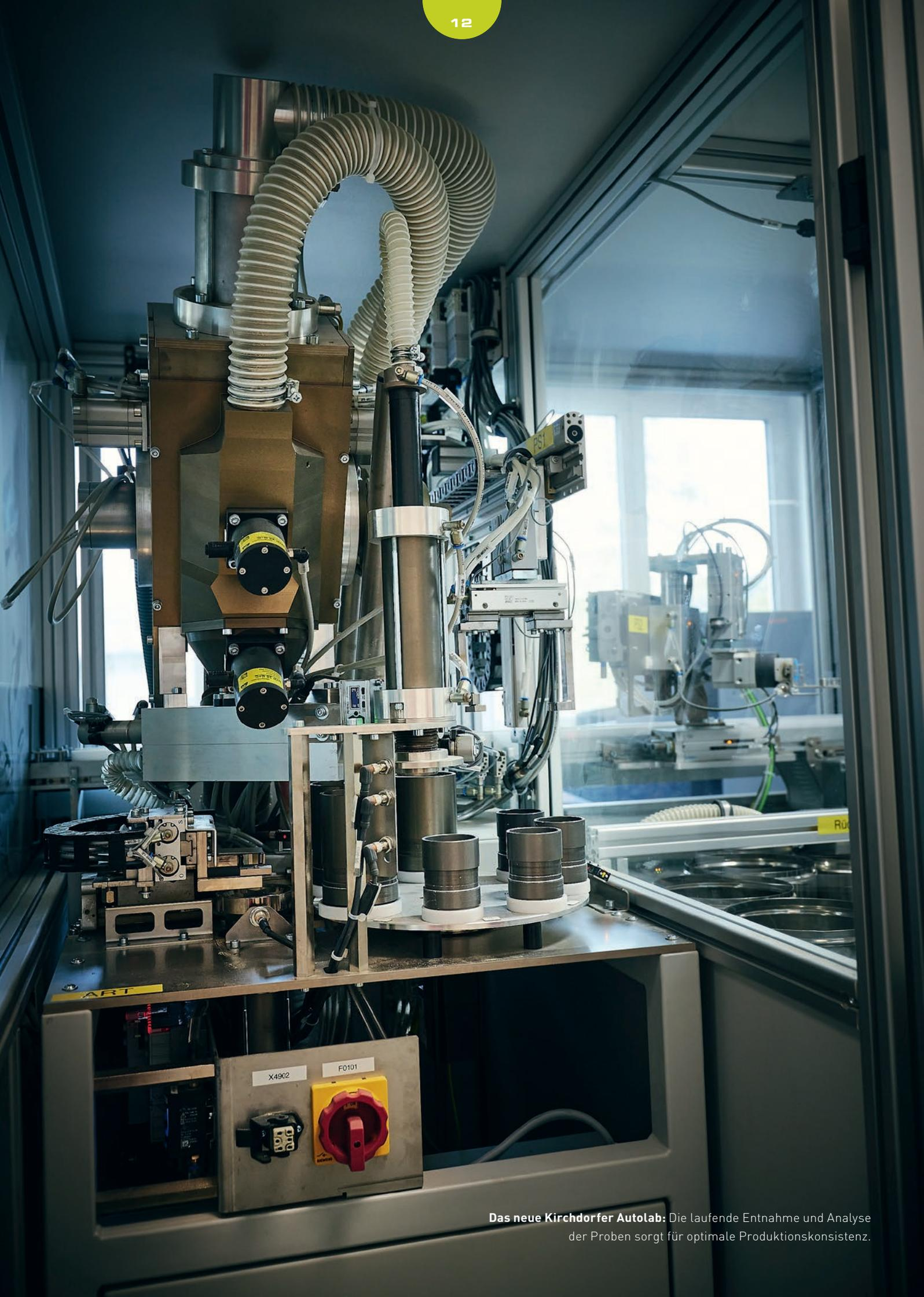
**Das neue Kirchdorfer Autolab:** Die laufende Entnahme und Analyse der Proben sorgt für optimale Produktionskonsistenz.
